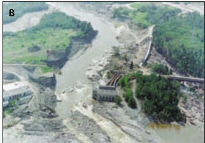
Figure 20 : Changement majeur du lit d'un cours d'eau : secteur de la Chute Garneau (rivière Chicoutimi) avant (A) et après (B) les événements de juillet 1996 (Source : Hydro-Québec, photographies aériennes TransÉnergie, 443 5082)
